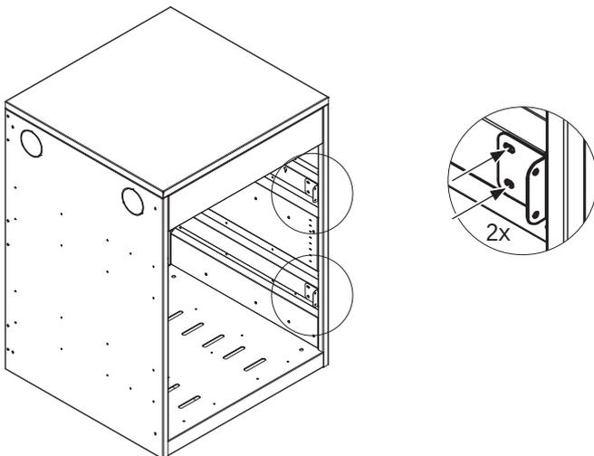
**5b** Montieren Sie den Magnet mit 2 Stk. Flachrundkopfschrauben an der Tür.
