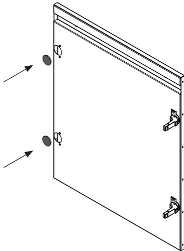
**5a** Montieren Sie die 2 Stk. Türanschlagbleche mit 2 x 2 Stk. Flachrundkopfschrauben.
