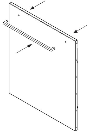
**7** Richten Sie die Tür an den Stellschrauben ein und justieren Sie den Anschlag mit den Anschlagblechen.
