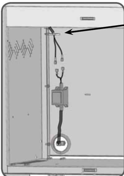
Lampen-Kabel mit dem mitgelieferten Schlauchhalter-Clip am Seitenpaneel befestigen.
