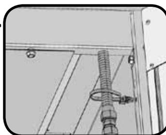
Schlauch Mit Dem Mitgelieferten Schlauchhalterclip Am Seitenpanel Befestigen.
