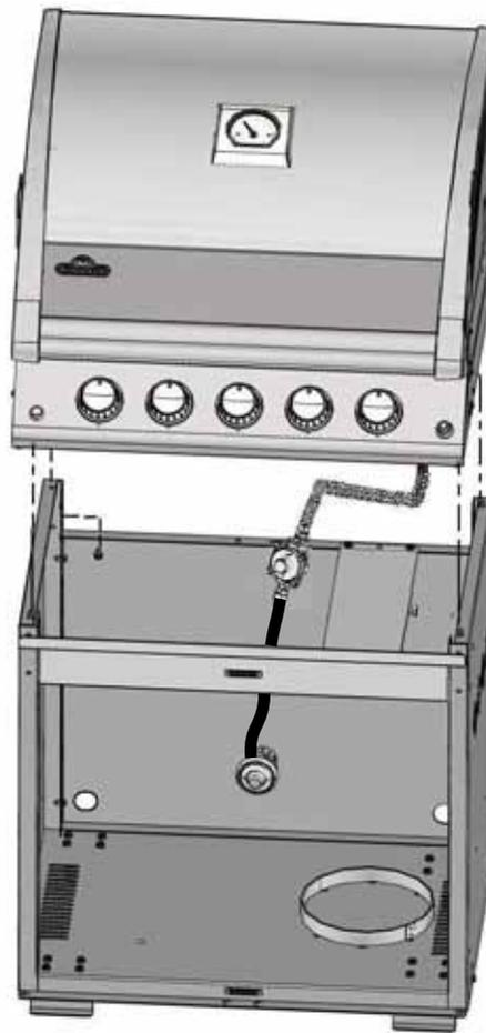
Druckregler mit zwei 8-32 x 3/8"-Schrauben festdrehen.
