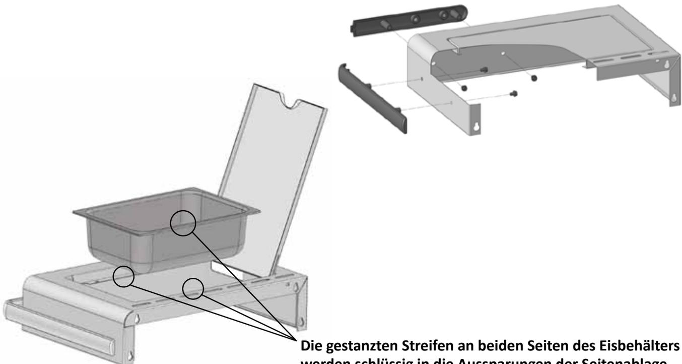
Die gestanzten Streifen an beiden Seiten des Eisbehälters werden schlüssig in die Aussparungen der Seitenablage eingesetzt.
