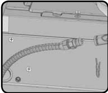
Öffnung in die Brennerleitung einpassen und mit dem beiliegenden Schlauchhalter-Clip sichern.
