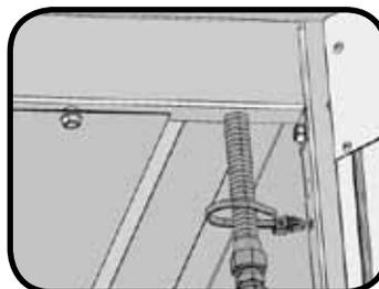
Schlauch Mit Dem Mitgelieferten Schlauchhalterclip Am Seitenpanel Befestigen.
