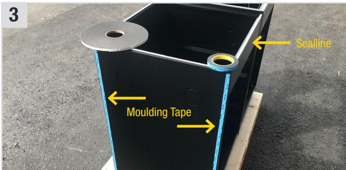
**3** **Moulding Tape** (Doppelseitiges Klebeband) an der Seitenwand anbringen und fest andrücken. **Sealline** (Schaumklebeband bzw. Abstandsband) auf Auflagerahmen anbringen.
