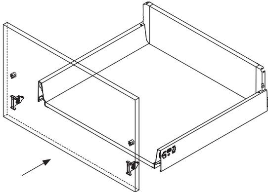
**6** Verbinden Sie mit der Längsreile die Stahlrückwand mit der Frontblende (li + re).
